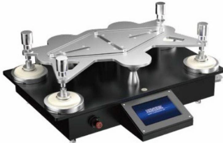
**YG401H马丁代尔耐磨及起球性能试验仪(翻盖式)** 仪器特点 1. 采用工业级彩色触摸屏显示、控制，友好的人机界面简单易用，操作更方便。中、英文显示可转换。 2. 每个工位单独计数，可以分阶段设置转数，进程条图形显示试验过程。具有磨料寿命自动提示功能。 3. 可对试验阶段（共8级）及每个阶段的试验次数进行编程，也可重复运行单一程序，以适应各种试验要求。 4. 试样夹具运动导板翻板式设计，磨料装夹操作更方便。 5. 采用直流无刷电机控制技术，转速数字设定也可以设置三种速度，能满足国内国外所有的方法标准。 6. 具有断电自动恢复到工作状态功能，即意外断电再次上电后能自动启动运转直至试验完成。 7. 主要部件采用铝合金材质，
