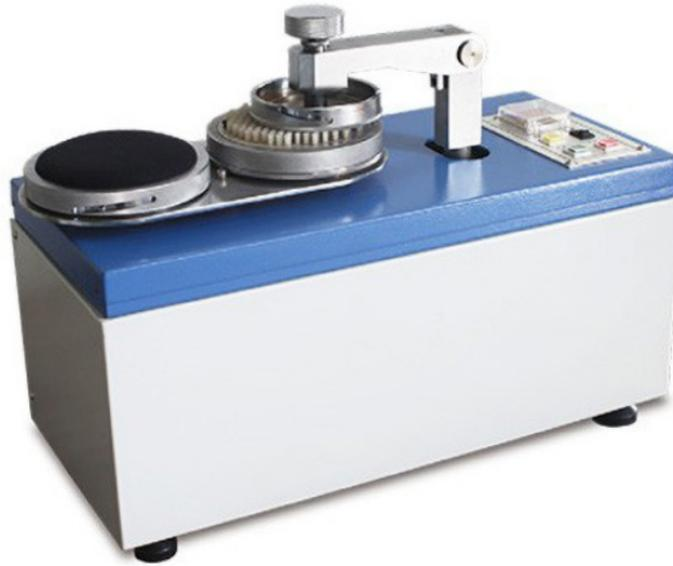
**HD471纺织品负离子测试仪适用范围** 用于采用纺织品经摩擦作用时激发出负离子发生量的测试。**仪器特性** 在一定体积的测试仓中，将试样安装在上下摩擦盘上，在规定条件下进行擦。用空气离子测量仪测定试样与试样本身相互摩擦时在单位体积空间内激发出负离子的个数，并记录负离子发生量随时间变化的曲线。**适用标准** GB/T4745-2012;ISO4920;AATCC22 **技术参数** 1. 测试仓 $\square$ 300mm\*560mm\*210mm 2. 离子分辨率：10个/cm<sup>3</sup> 3. 离子测量范围：10-1 999 000 个/cm<sup>3</sup> 4. 上摩擦盘直径 $\square$ 100mm $\pm$ 0.5mm 5. 下摩擦盘直径 $\square$ 200mm $\pm$ 0.5mm 6. 上下摩擦盘回转中心偏置距离 $\square$ 50mm $\pm$ 0.5mm
